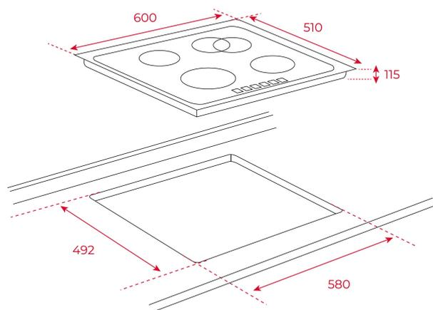
**MASSE****Höhe (mm):** 115**Breite (mm):** 600**Tiefe (mm):** 510**Länge (mm):****Gewicht (kg):** 7,68**TECHNISCHE DATEN**
