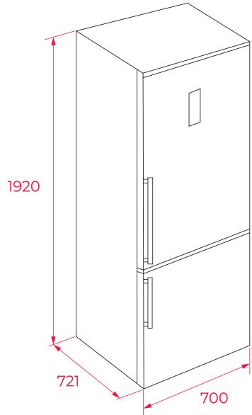
**MASSE****Höhe (mm):** 1920**Breite (mm):** 700**Tiefe (mm):** 712**Länge (mm):****Gewicht (kg):** 84**TECHNISCHE DATEN**
