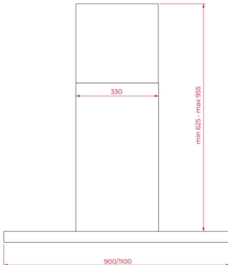
**MASSE****Höhe (mm):** 670-1000**Breite (mm):** 900**Tiefe (mm):** 480**Länge (mm):****Gewicht (kg):** 16.64**TECHNISCHE DATEN**
