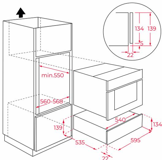
**DIMENSIONES****Altura del producto (mm):** 140**Anchura del producto (mm):** 595**Profundidad del producto (mm):** 557**Longitud del producto (mm):****Peso neto (kg):** 18**ESPECIFICACIONES TÉCNICAS**
