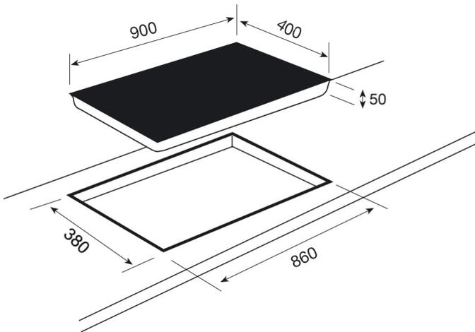
**DIMENSIONES****Altura del producto (mm):** 50**Anchura del producto (mm):** 900**Profundidad del producto (mm):** 400**Longitud del producto (mm):****Peso neto (kg):** 11,9**ESPECIFICACIONES TÉCNICAS**
