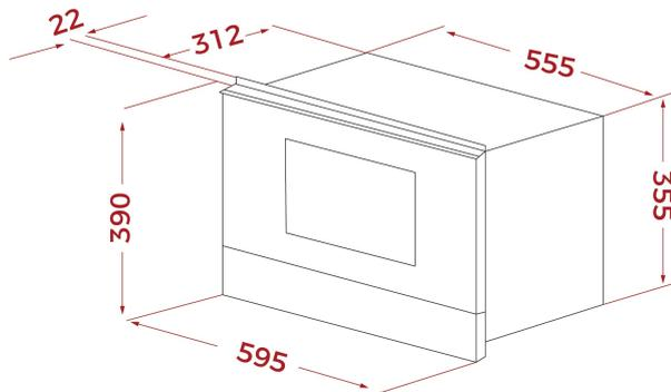
**DIMENSIONES****Altura del producto (mm):** 390**Anchura del producto (mm):** 595**Profundidad del producto (mm):** 334**Longitud del producto (mm):****Peso neto (kg):** 23,2**ESPECIFICACIONES TÉCNICAS**
