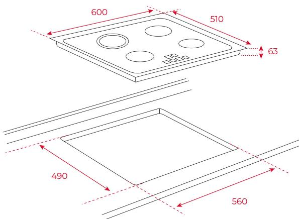
**Altura del producto (mm):** 51**Anchura del producto (mm):** 600**Profundidad del producto (mm):** 510**Longitud del producto (mm):****Peso neto (kg):** 8,7**ESPECIFICACIONES TÉCNICAS**
