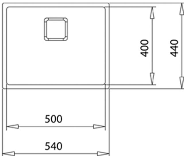
**DIMENSIONES****Altura del producto (mm):****Anchura del producto (mm):** 440**Profundidad del producto (mm):** 200**Longitud del producto (mm):** 540**Peso neto (kg):** 4,1**COLORES**
