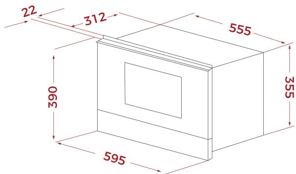
**Altura del producto (mm):** 390**Anchura del producto (mm):** 595**Profundidad del producto (mm):** 334**Longitud del producto (mm):****Peso del producto (Kg):** 23,2**ESPECIFICACIONES TÉCNICAS**
