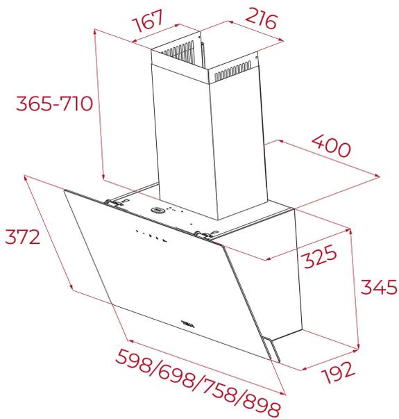
**DIMENSIONS****Hauteur du produit (mm):** 690-1035**Largeur du produit (mm):** 898**Profondeur du produit (mm):** 325**Longueur du produit (mm):****Poids net (kg):** 9,82**SPÉCIFICATIONS TECHNIQUES**
