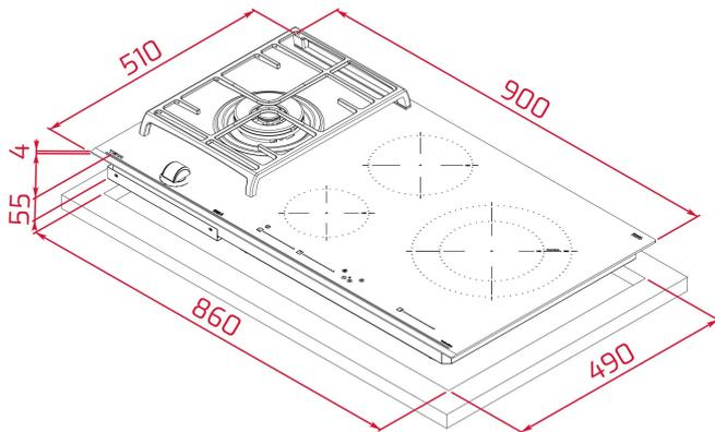
**DIMENSIONS****Hauteur du produit (mm):** 98**Largeur du produit (mm):** 900**Profondeur du produit (mm):** 510**Longueur du produit (mm):****Poids net (kg):** 16,4**SPÉCIFICATIONS TECHNIQUES**
